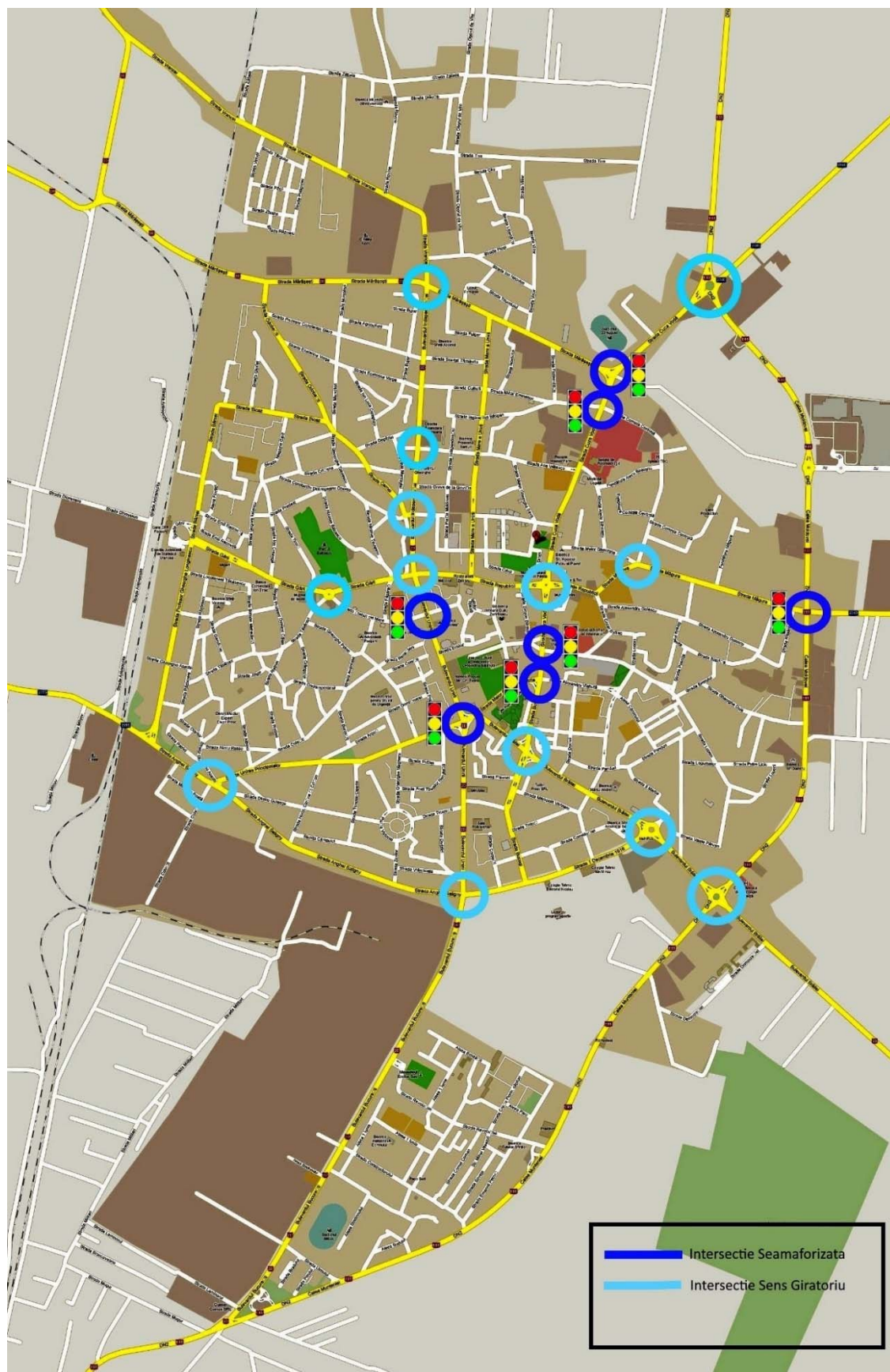
Fig. 2.6. Localizarea intersecțiilor semaforizate și a sensurilor giratorii 1
