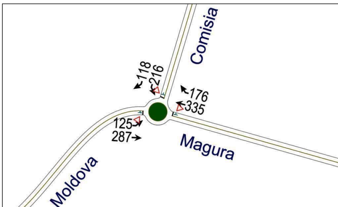
Fig. 4.38. Str. Moldova - Str. Măgura - schița intersecției
